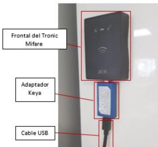
Figura 3: Conexión de los cables a una cerradura
